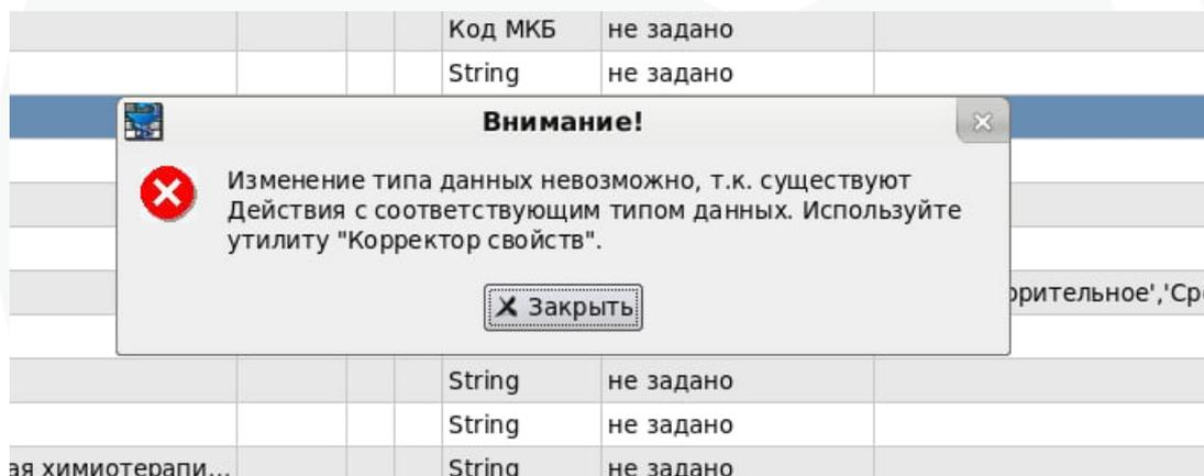
Для изменения типа данных необходимо предварительная настройка типа действия. А именно: если мы хотим изменить тип данных у свойства, то нужно добавить новое свойство в требуемый тип действия с таким же наименованием, но другим типом данных.
